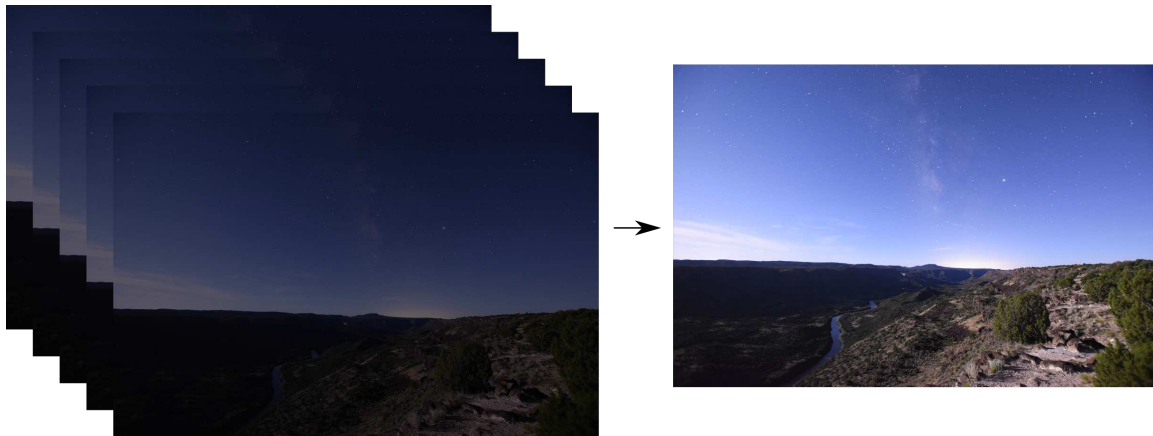
FIGURE 1.2 – Exemple de superposition d’images provenant de la même vue (scène), avec à gauche un ensemble de 5 d’images captées la nuit par le même appareil photo. À droite, on peut voir l’empilement de l’ensemble des 5 images en les moyennant pixel à pixel, afin d’améliorer la luminosité.
